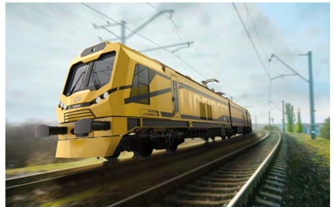
Hochleistungs-Schienenfrästechnik mit zwei unabhängigen Antrieben (Foto: Linsinger).
