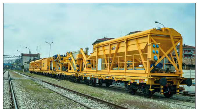
WAGON MIX 1500 ist eine eigenständige, schienengebundene Betonmischanlage (Foto: EUROMECC SRL).
