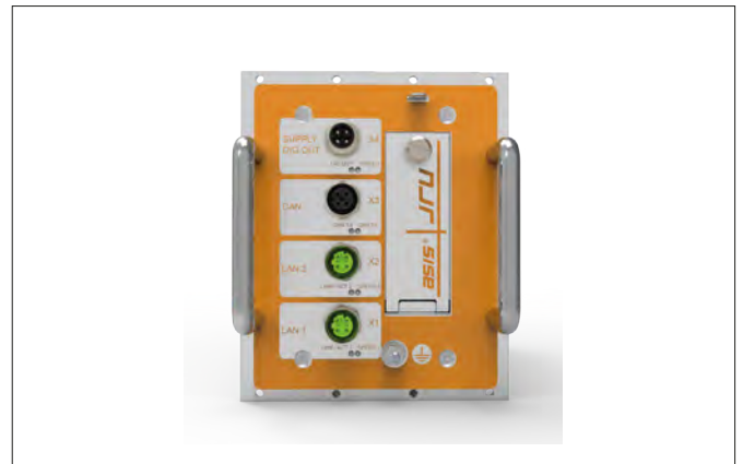
Die asisJRU ist eine moderne Juridical Recording Unit zur zuverlässigen und normkonformen Aufzeichnung von Betriebs- und sicherheitsrelevanten Daten in Bahnanwendungen (Foto: SYNICS AG).
