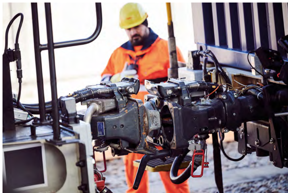
Demonstration der automatischen Kupplung; die Komplexität ist zu erkennen (Foto: ÖBB/Marek Knopp).
