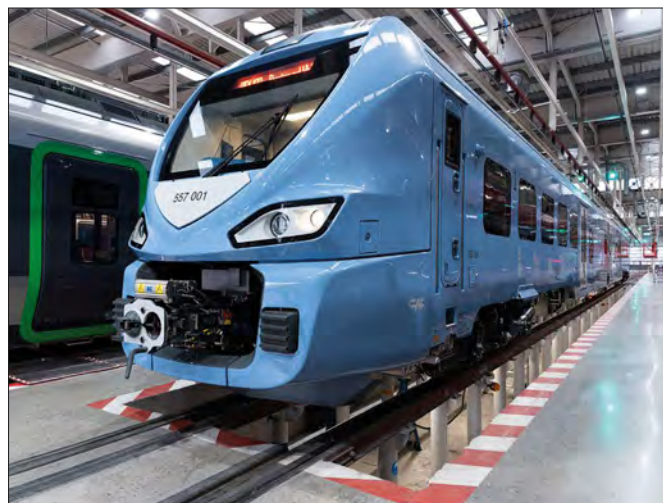
Batteriebetriebener Triebzug CIVITY BEMU (Foto: CAF).
