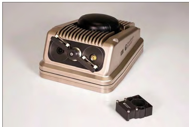
Kabellosen Beschleunigungsmesser (Foto: Transmission Dynamics).
