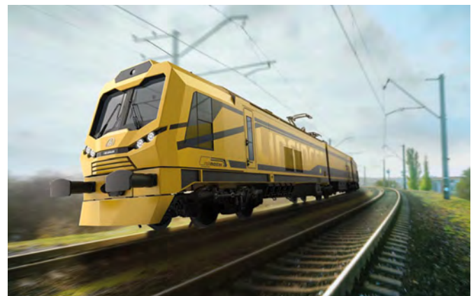
Hochleistungs-Schienenfrästechnik mit zwei unabhängigen Antrieben (Foto: Linsinger).
