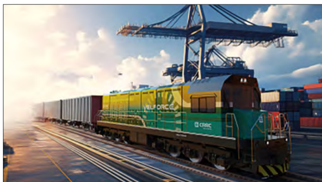
2000-kW-Wasserstoff-Brennstoffzellen-Hybridlokomotive (Foto: CRRC Group).
