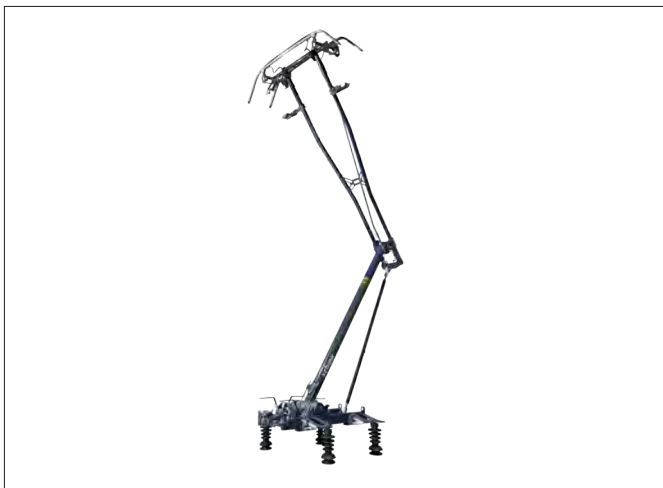
„High Reach“-Stromabnehmer (Foto: Schunk Transit Systems GmbH).
