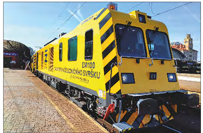
Messwagen für die Oberbaudiagnose EM100 (Foto: NDCon Logic).
