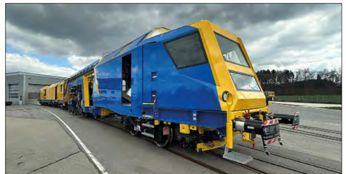
Die neue Stopfmaschine S7 CPLS 32 4.0 (Foto: Spitzke).
